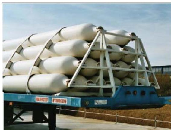
**Figura 23** – Depósitos de CGH<sub>2</sub> no Luxemburgo<sup>[8]</sup>
