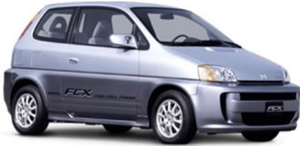
O FCX tem uma potência de 80 cv e atinge uma velocidade máxima de 150 km/h. O depósito de hidrogénio a 5000 psi permite uma autonomia de 350 km.
