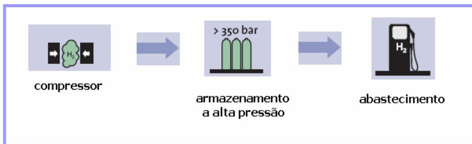
Figura 19 – Abastecimento *Overflow* <sup>[8]</sup>
